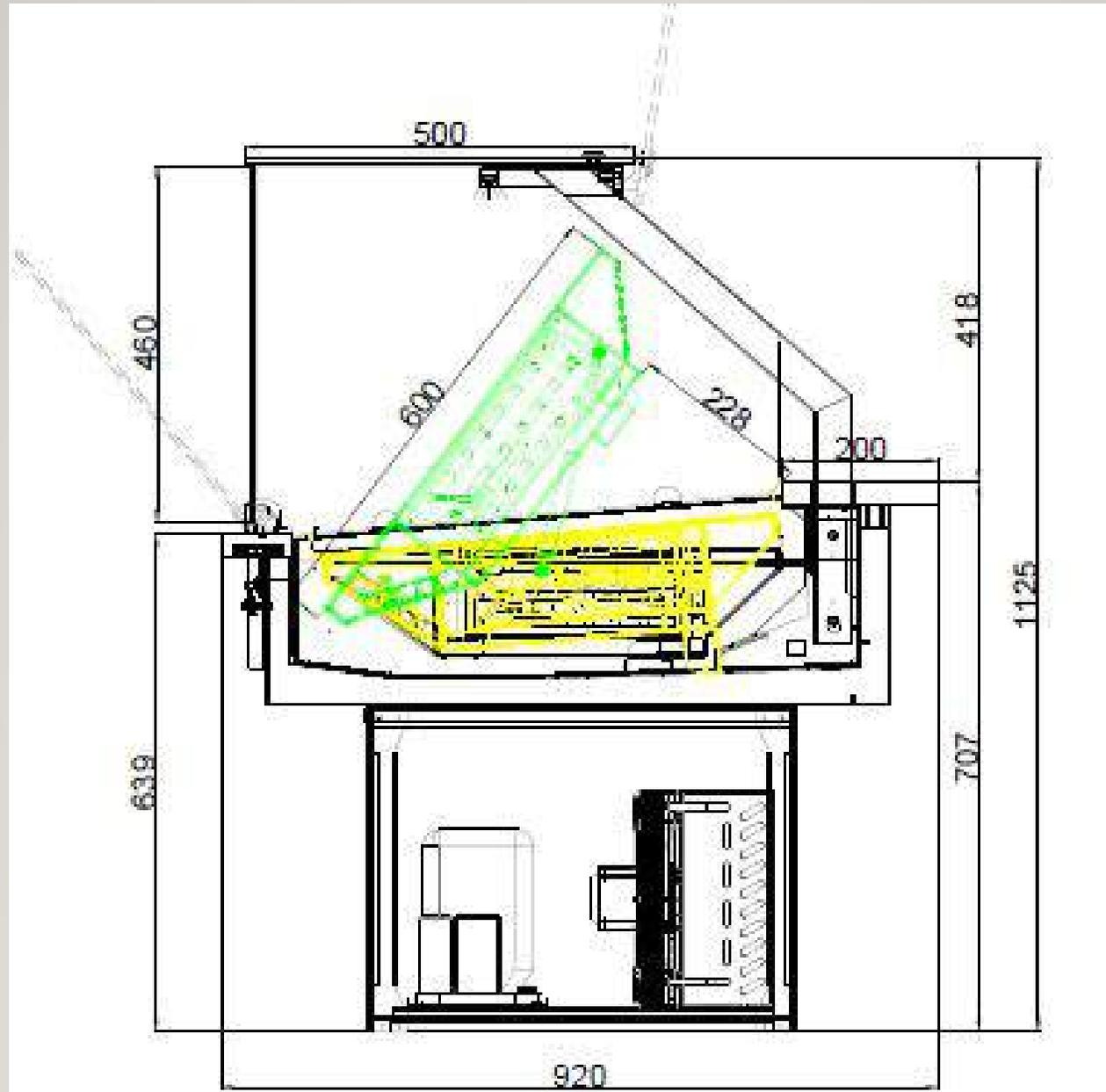
Подъемный поддон вместе с блоком испарителя и вентиляторами и «раскрывающаяся» стеклянная надстройка витрины делают ежедневную уборку быстрой и удобной.
